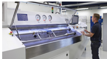
Banco de pruebas de caudal para aceite hidráulico y agua, con capacidad de hasta 300 l/min.
